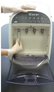
Fig. 14 - Collegamento delle turbine
