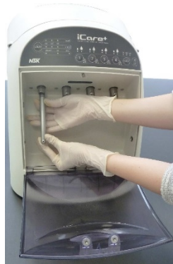
Fig. 15 - Avvitare l'anello di tenuta
