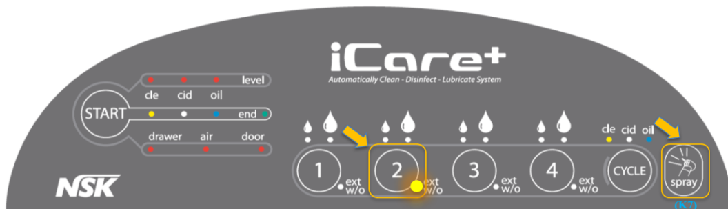
Fig. 28 - Strumento senza spray interno
