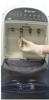
Fig. 17 - Collegamento di un contrangolo
