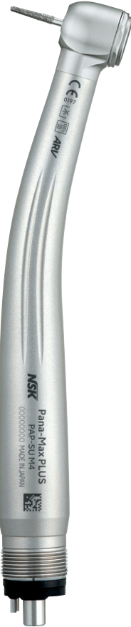
Testina Standard Velocità : 340.000-410.000 min -1 Dimensione testina : ø12,1 x H 13,3 mm
